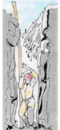
Sul ciglio degli scavi devono essere vietati i depositi di materiali, l'installazione di macchine pesanti o fonti di vibrazioni e urti, il passaggio e la sosta di veicoli.
