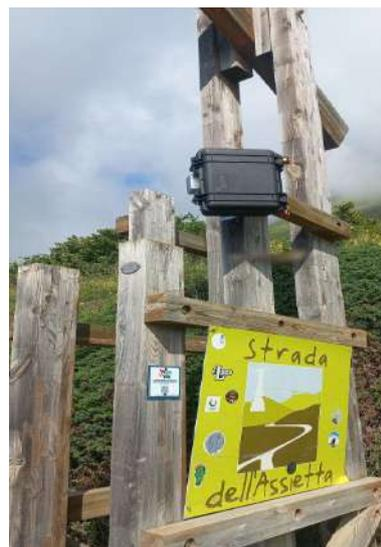
Per i monitoraggi delle emissioni sono stati posizionati due differenti sistemi di acquisizione, per quelle gassose (ossidi di azoto NO<sub>2</sub>) vengono utilizzati sistemi di captazione radiali e dei deposimetri per catturare le polveri.
