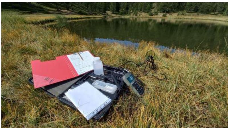
*Sonde multiparametro, schede e materiali per il prelievo delle acque presso il Lago Clot-Foiron*
